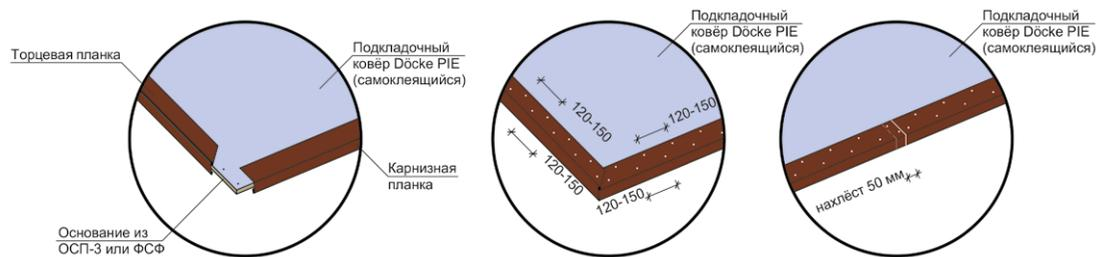
Рис. 13. Крепление металлических карнизных и торцевых планок.
