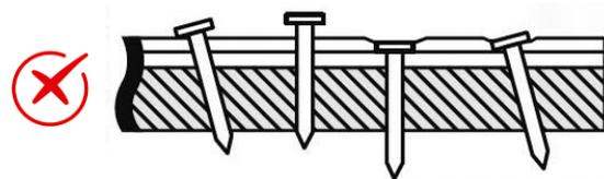
Рис. 3. Пример неправильной забивки гвоздей при монтаже продукции.
