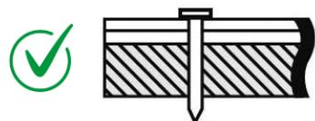
Рис. 2. Пример правильной забивки гвоздей при монтаже продукции.
